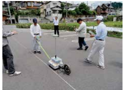
写真18 地中レーダー探査
