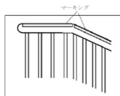
図16-33 階段のシンボルを用いた階段始点用の標示の参考例
