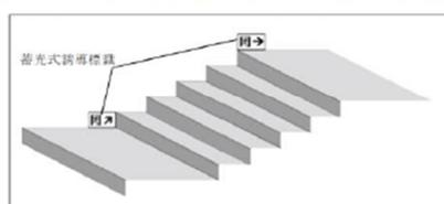
※ 避難する際の錯覚（踏み面がきわめて暗い環境のため、階段なのか踊り場なのかを判断できない）による転倒、転落等を防ぐため、蓄光式誘導標識の設置高さは、統一した設置箇所とすることが望ましい。
